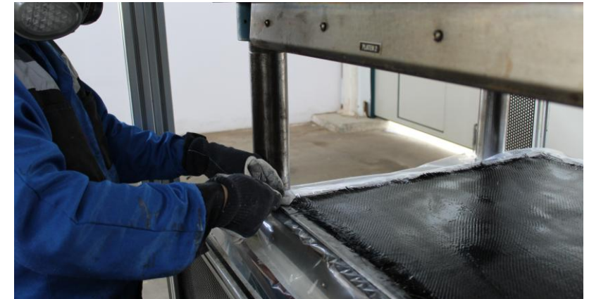
Изготовление ПКМ методом прессования
