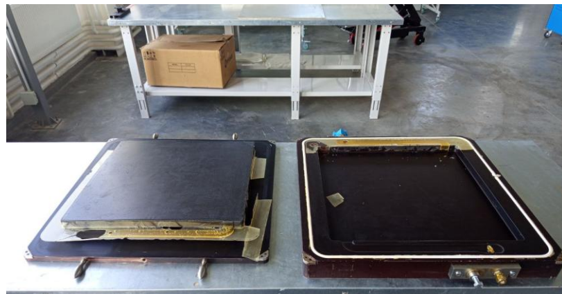
Изготовление ПКМ методом инжекции под давлением
